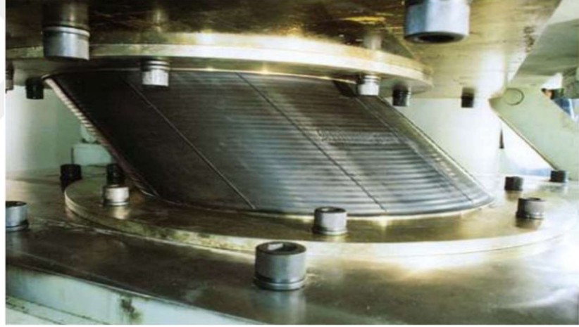
Şekil 2.7. Kauçuk esaslı elastomerik izolatörün testler sırasındaki şekil değiştirmesi
