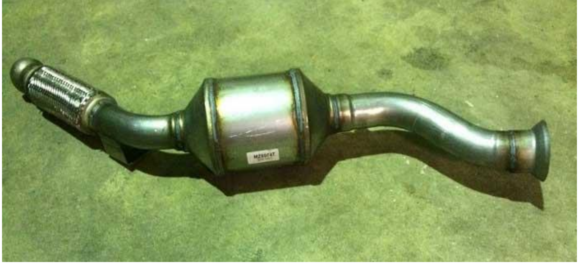
Şekil 2.10. İçten yanmalı benzinli motor katalitik konvertörü (Matay 2016)
