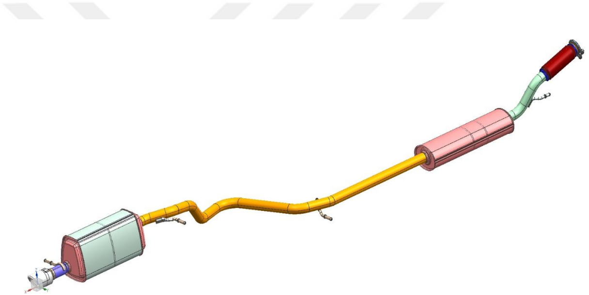
Őekil 4.3. İten yanmalı bir benzinli motor egzoz emisyon sistemi
