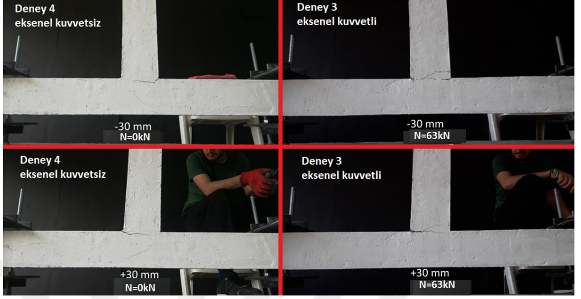
Şekil 4.16. -30/+30 milimetrelık deplasman sonucunda birleşim bölgelerinde oluşan çatlaklar (Deney 3 ve Deney 4)
