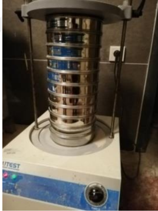
Şekil 3.12. Elek analizi makinesi
