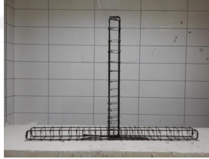
Şekil 3.18. Numunelerin donatı montajının bitmiş hali
