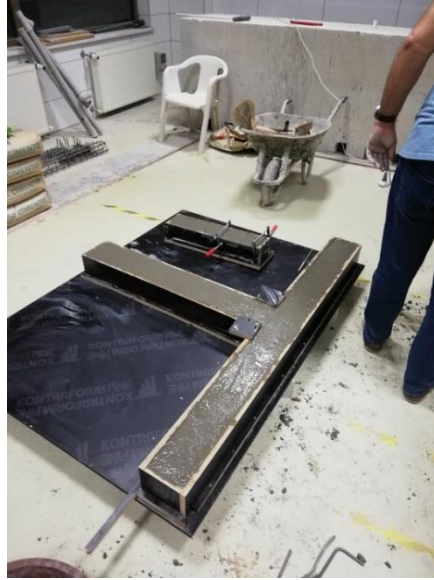
Şekil 3. 20. Üretilen betonun kalıba yerleştirilmesi
