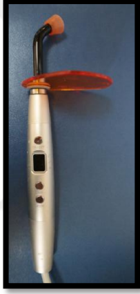
Resim 7: Dyract XP'yi polimerize etmek için kullanılan Monitex BlueLEXTMLD- M1C ışık cihazı
