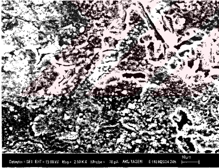
Şekil 5.4 E160 alaşımının SEM mikrofotografaları a) çıplak yüzey b) HCl c) HCl + 3mlp3ol d) H 2 SO 4 e) H 2 SO 4 + 3mlp3ol
