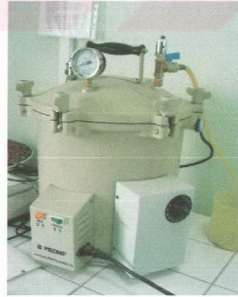
Şekil-3.4.1. Basınçlı Buhar Kürü Uygulamasında Kullanılan Otoklav
