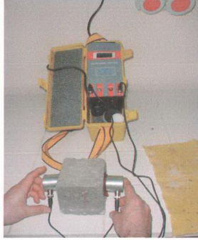
Şekil-3.3.4. Ultrases Hızı Ölçümünün Yapılışı
