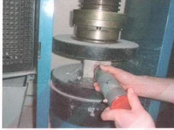
Şekil-3.3.3. Schmidt Çekici Okumalarının Yapılışı
