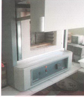
Şekil-3.3.7. Yangın Dayanım Deneyi İçin Kullanılan Fırın
