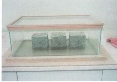
Şekil-3.3.6. Numunelerin Kılcal Su Emme Deney Düzeneği
