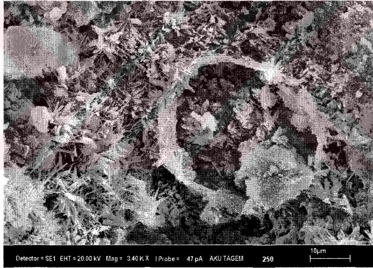
Şekil-5.9.2. Diyatomitle Üretilen 250 Dozlu Numunelerde Oluşan Etrenjitin SEM Görüntüsü
