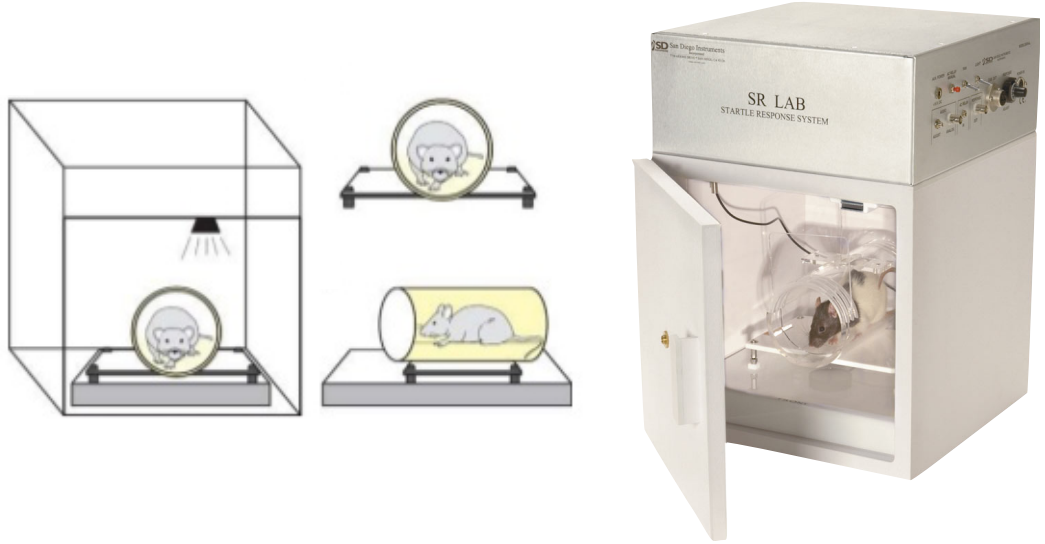
Şekil 8 : ÖUAİ testinde kullanılan düzenek (SR-LAB, San Diego Instruments'dan alınmıştır).
