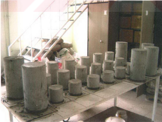
Şekil 3.8 Silindir Numunelerin Başlıklanması İşlemi
