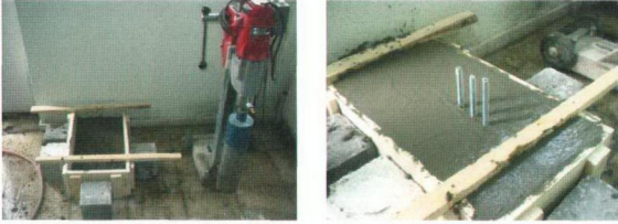
Şekil 3.6 Karot Alma Cihazının Sabitleştirilmesi
