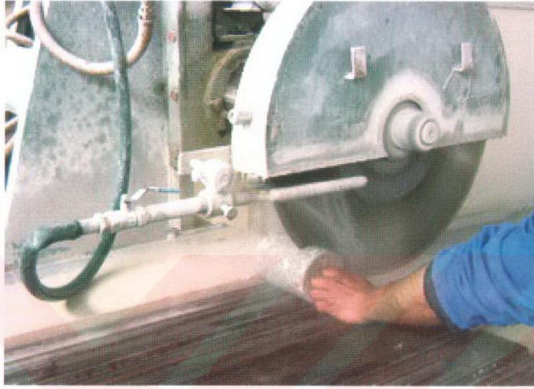
Şekil 3.7 Karot Numunelerin Baş Kesme İşlemi
