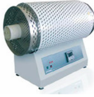
Şekil 3.2 Sinterlemede kullanılan tüp fırın
