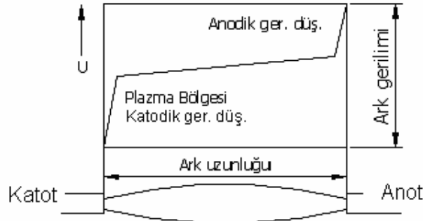
Şekil 2.4 Elektrik arkı mekanizmasının şematik gösterilişi
