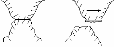
Şekil 6.2 Adhezif aşınmanın meydana gelişinin şematik olarak gösterimi
