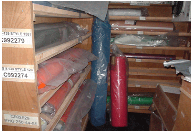
Şekil 5.2 Prepreg malzemelerin -18 °C’de saklandığı buzdolabın iç görüntüsü.
