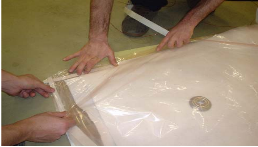
Şekil 5.13 Vakum torbası etrafına yalıtıklılık için sızdırmazlık bandının yapıştırılması.
