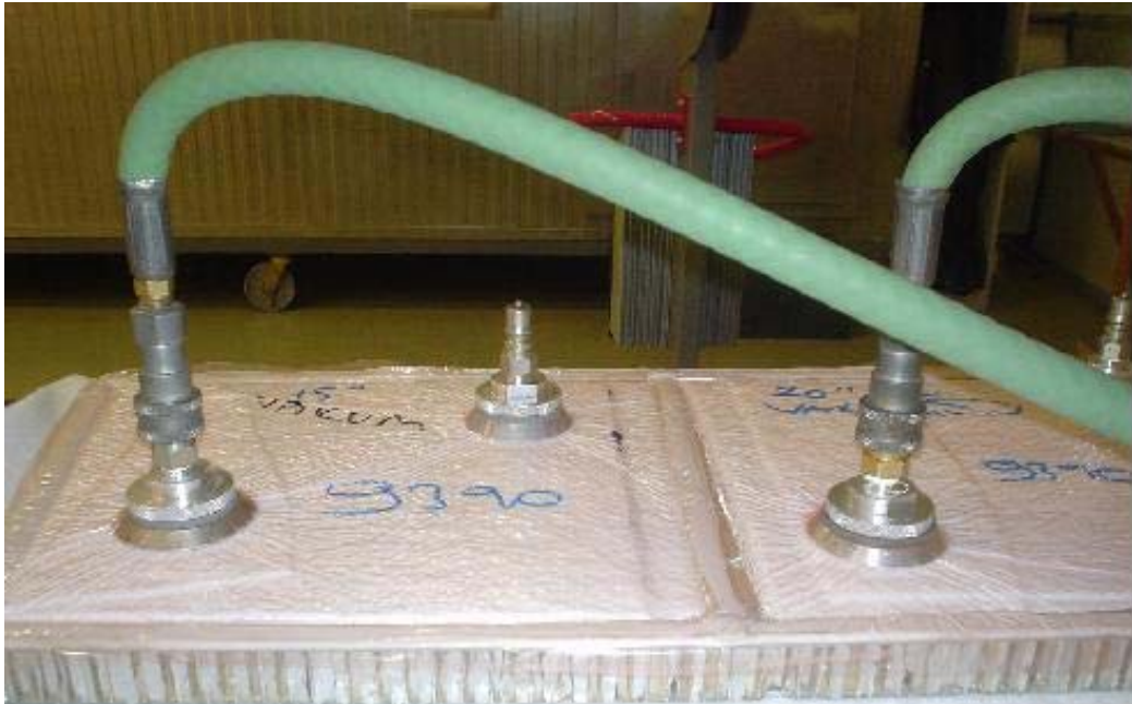
Şekil 5.15 Parçaların vakum portları takılarak istenilen miktarda basınca alınması.
