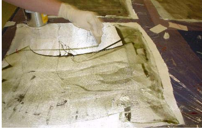
Şekil 5.23 Cam kumaşın üzerine reçinenin emdirilmesi.
