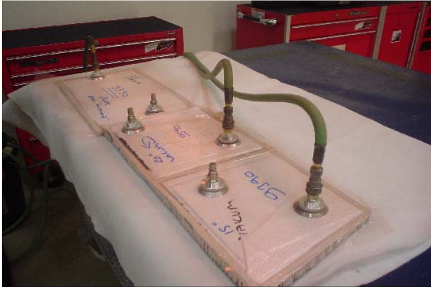
Şekil 5.26 15, 20, 25 İnhg basınçında cam kumaşından elle yayma tekniği ile üretilen parçaların vakuma alınmış durumları.
