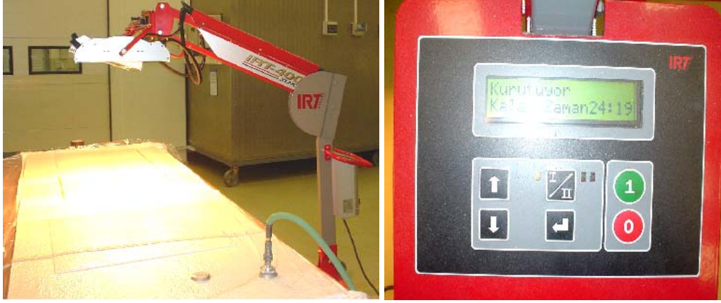
Şekil 4.7 Isı kontrol lambası ile yüzeyin kurutulması, ısının ve zamanın kontrol edilmesi.
