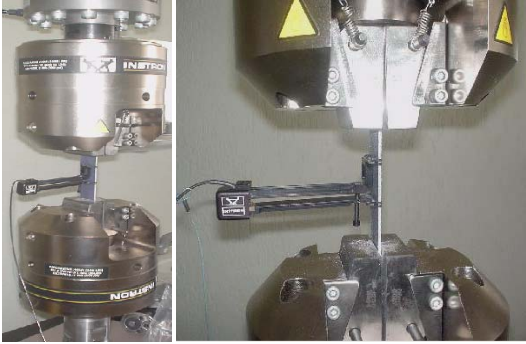
Şekil 5.38 Ekstantiyometrenin deney parçalarına bağlanması.
