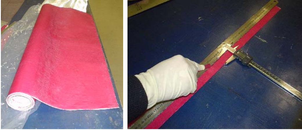
Şekil 5.30 Film yapıştırıcının kesilmesi.
