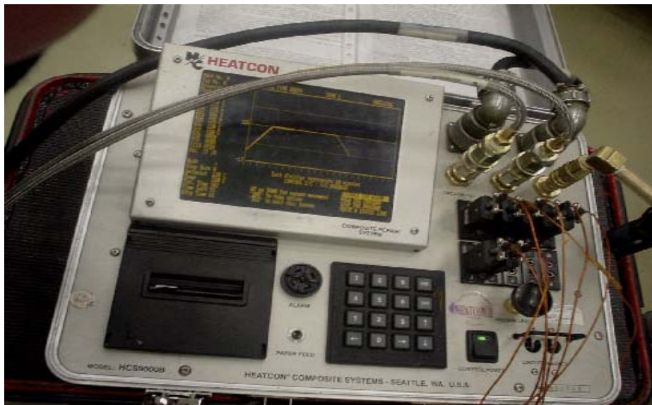
Şekil 5.12 Hot bonder cihazında ısı çiftler ile parçaya uygulanan ısının kontrollerinin yapılması.
