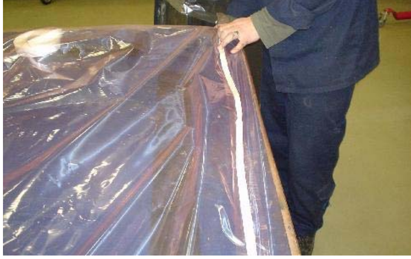
Şekil 5.6 Malzemelerin dış ortam ile sızdırmazlığının sağlandığı vakum naylonunun hazırlanması.
