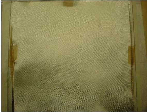
Şekil 5.8 Fiberglas bleeder’in ayırıcı film üzerine yerleştirilmesi.
