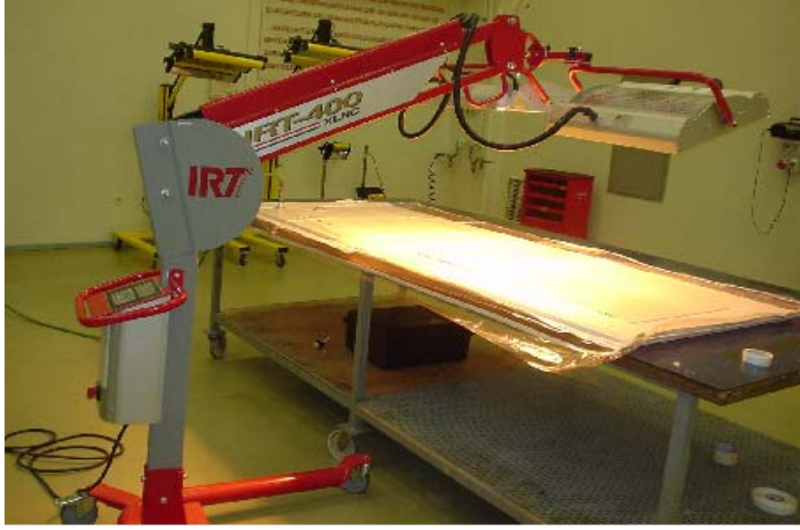
Şekil 5.27 Elle yayma tekniği ile parçaların ısıveren lamba altında kür edilmesi.
