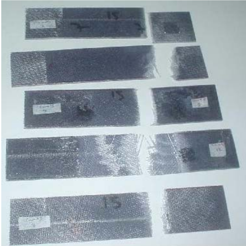
Şekil 5.49 Düz parça olarak yapışmış cam kompozit parçaların yorulma deneyi sonucu kopmuş halleri.
