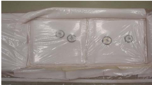
Şekil 5.10 Battaniyenin (air weave) vakum işlemi için üretilecek parçaların etrafına sarılması.
