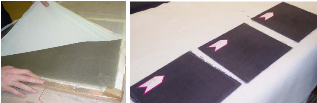
Şekil 5.28 Cam kumaşından elle yayma metodu ile kür edilen parçalar.
