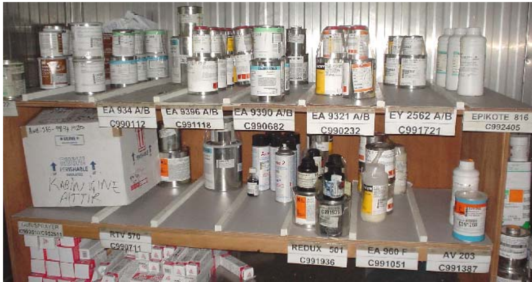
Şekil 5.20 Reçinelerin +4^\circ\text{C} 'de saklandığı dolabın iç görüntüsü.
