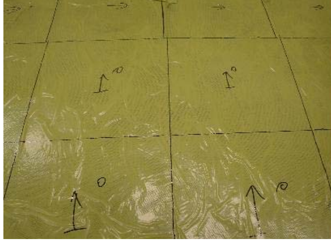
Şekil 5.3 Prepreg malzeme üzerine istenilen açı ve ölçülerde çizim yapılarak kesilmesi.
