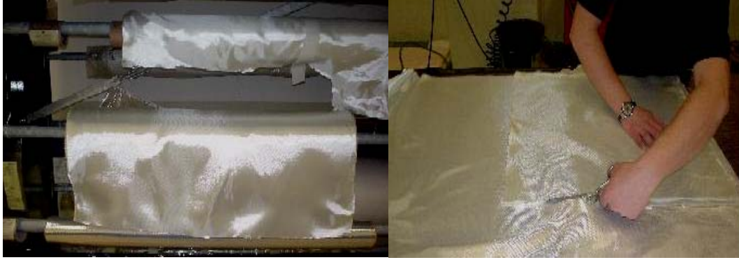
Şekil 5.19 Cam kumaşının istenilen açılara göre kesilmesi.
