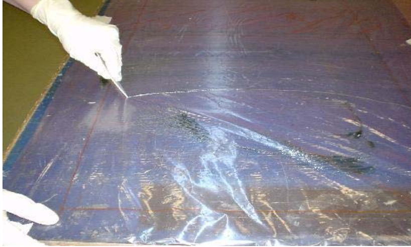
Şekil 5.22 Reçinenin en alta serili naylonun üzerine ilk katman olarak düzgünce yayılması.
