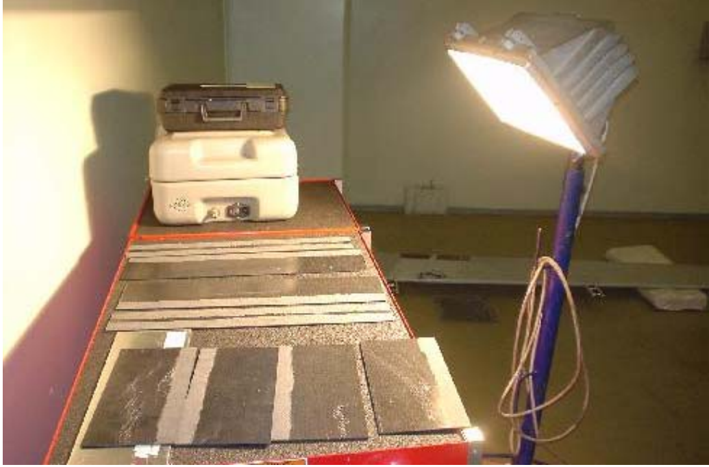
Şekil 5.29 Malzemelerin metil etil keton ile temizlendikten sonra lamba altında kurutulması.
