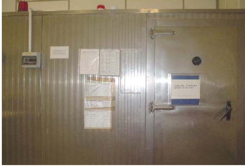
Şekil 5.1 Prepreg malzemelerin depolandığı derin dondurucu dolabın dıştan görünüşü.
