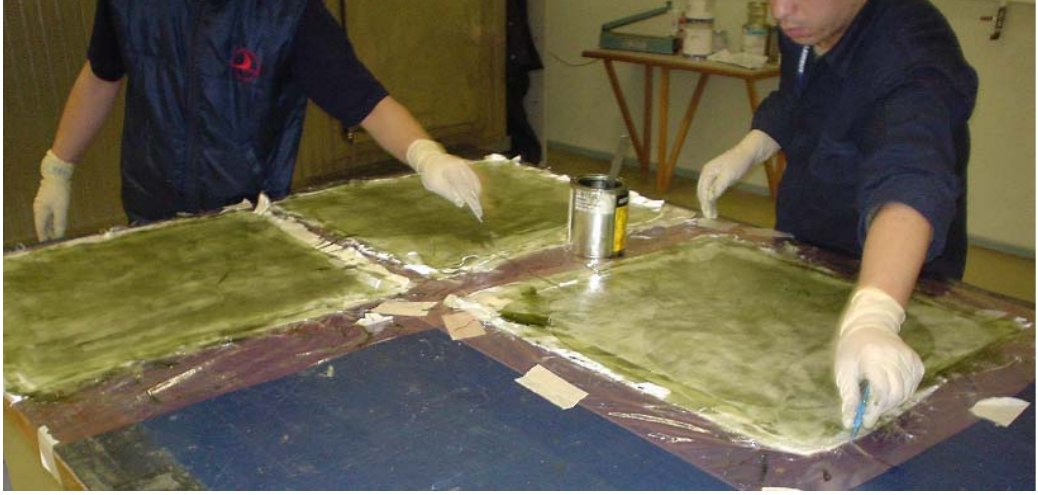
Şekil 5.24 Üsteki 8. kat cam kumaşın üzerine alt kısımda olduğu gibi reçinenin emdirilmesi.
