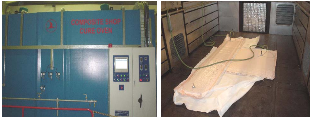
Şekil 5.33 Film yapıştırıcıların kür edildiği fırının dış ve iç görüntüsü.
