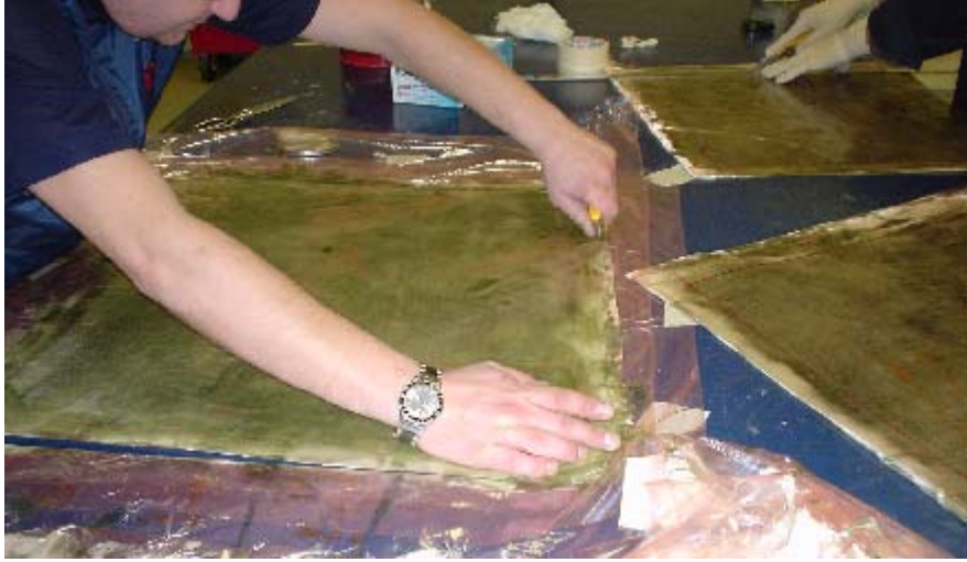
Şekil 5.25 Katların hepsi yerleştirildikten sonra üretilecek parçaların kenarlarının düzeltilmesi.
