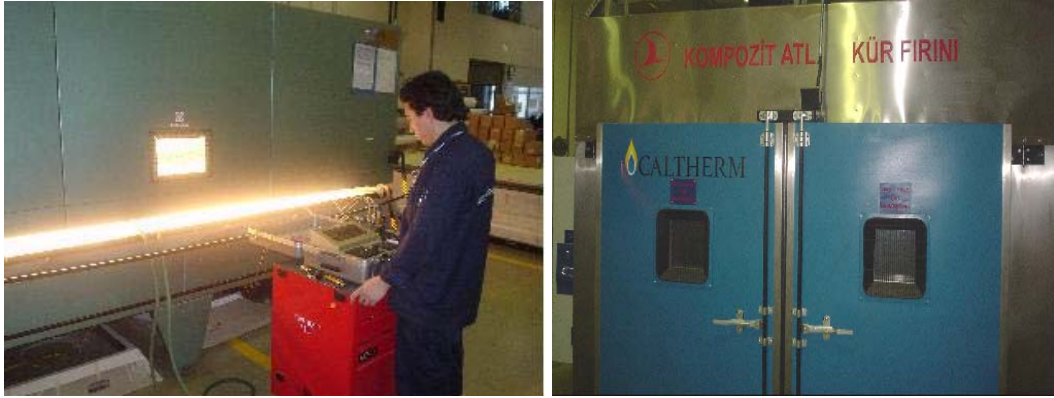
Şekil 5.17 Parçaların iki ayrı fırında kür işlemi ve hot bonder cihazı ile sıcaklığın ayarlanması.
