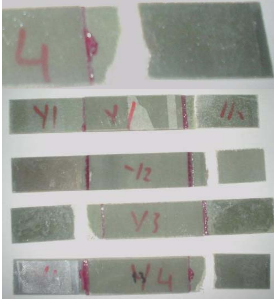
Şekil 5.56 Çift bindirme (double lap) olarak yapışmış cam kompozit parçaların yorulma deneyi sonucu kopmuş halleri.
