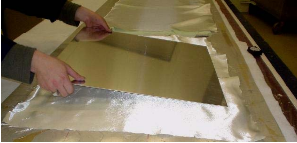
Şekil 5.9 Vakuma alma işleminde yüzey düzgünlüğü için alt ve üst kısma konulan levha.
