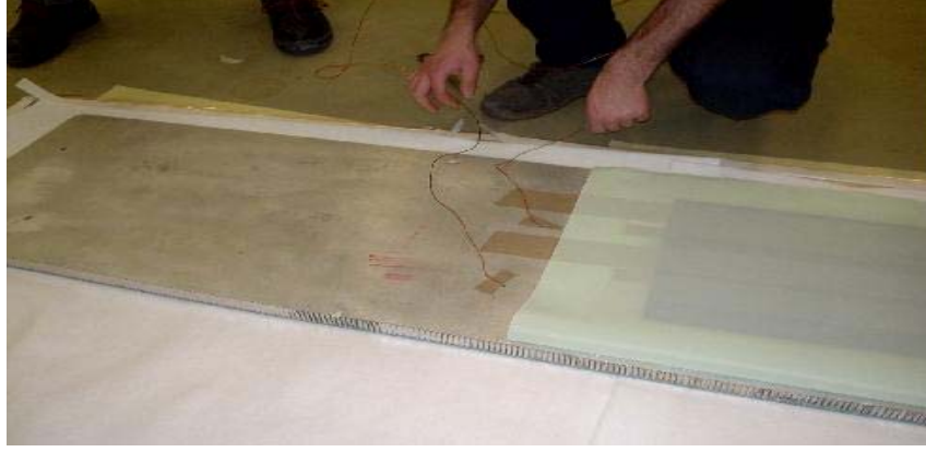
Şekil 5.11 Kür işlemi esnasında ısıyı sürekli takip etmek amacıyla konulan ısı çift (termocoupler).
