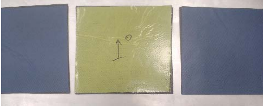
Şekil 5.5 Uygun açılarda kesilmiş parçaların açılardan sırasına uygun olarak üst üste yapıştırılması.
