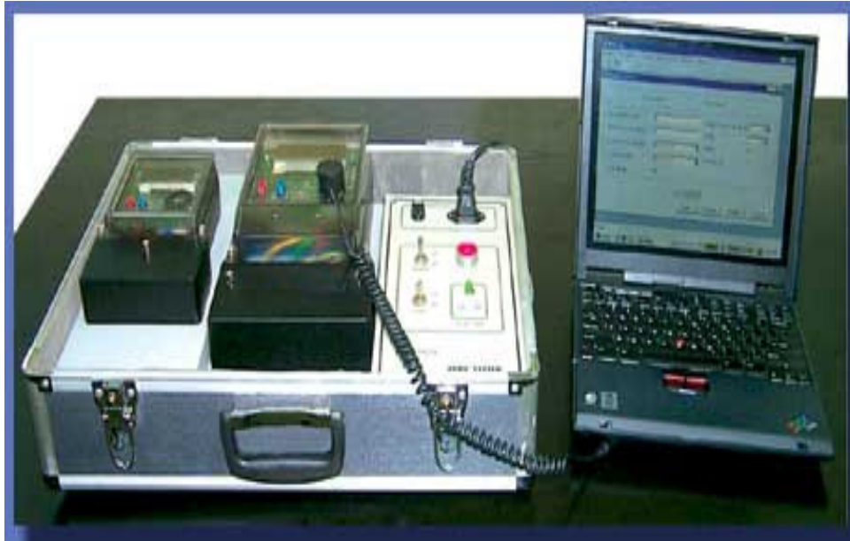
Şekil 3.5 Sayaçların PC Aracılığıyla Optik Porttan Okunması ve Set Edilmesi
