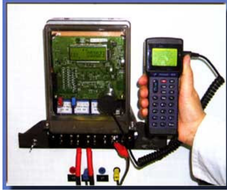
Şekil 3.4 Sayaçların El Terminali ile Optik Porttan Okunması
