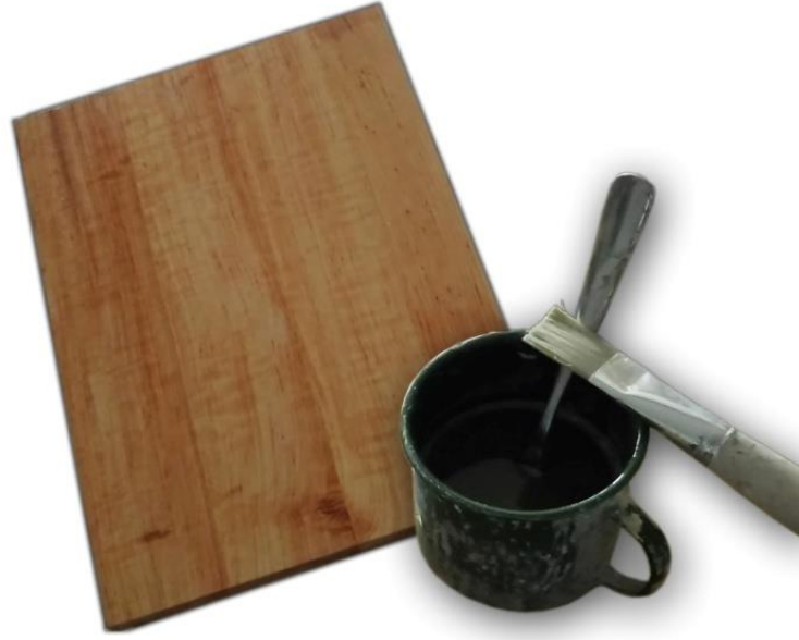
Görsel 2.47. Tutkal çözeltisinin ahşap panele uygulanması.
