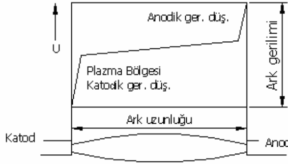
Şekil 3.4 Elektrik arkı mekanizmasının şematik gösterilişi
