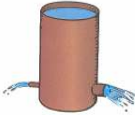
Şekil 1. Sabit bir sıvı basıncı için, kabın alt bölümüne monte edilmiş borulardan daha geniş olan borudan diğerine göre daha fazla su geçer. Benzer şekilde sabit bir potansiyel fark için, daha büyük çaplı olan telden diğerine göre daha fazla akım geçer.
