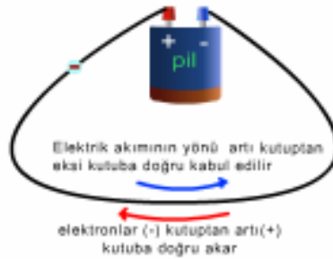
Şekil 2. Bir pil ve iletken telden oluşan devrede elektronların hareket yönü ve akım yönü
