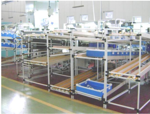
Şekil 29: Malzeme Rafları Yapılmış Montaj Hattı
