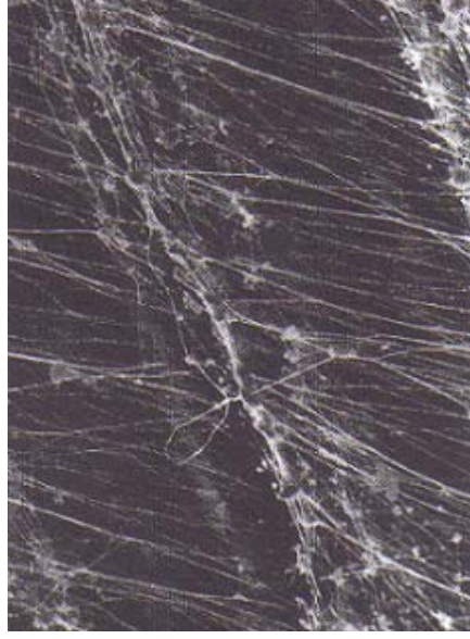
Resim 2.1 İki Eksenli Germe ile Üretilmiş PTFE Membran (Hardman 2000)
