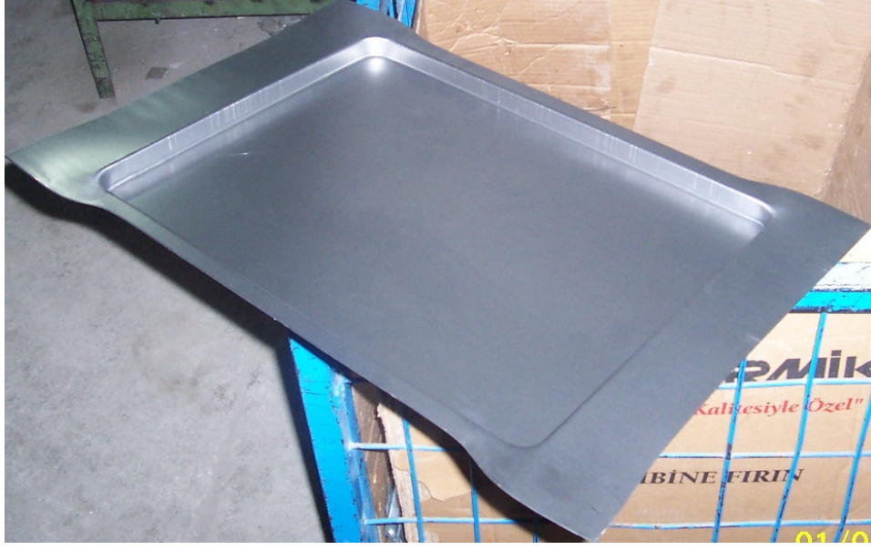
Şekil 5.2 Derin çekme işlemi sonucu parça üzerindeki kulaklanmalar
