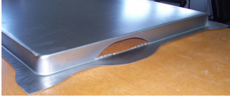
Şekil 3.11 Derin çekme işleminden sonra yırtılan parça
