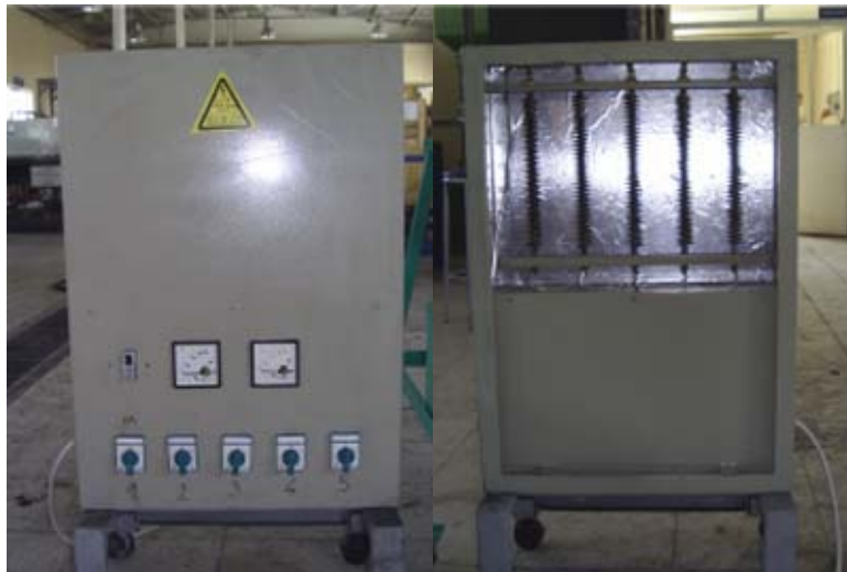
Resim 3.15 Test cihazını yüklemeye kullanılan rezistanslar
