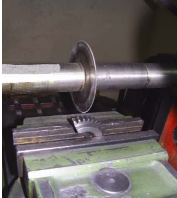
Resim 3.4 a Test dişlilerinin frezede kesilmesi
