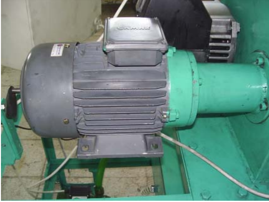
Resim 3.7 Gamak (3KW) elektrik motoru cihaz üzerine bağlanmış halde
