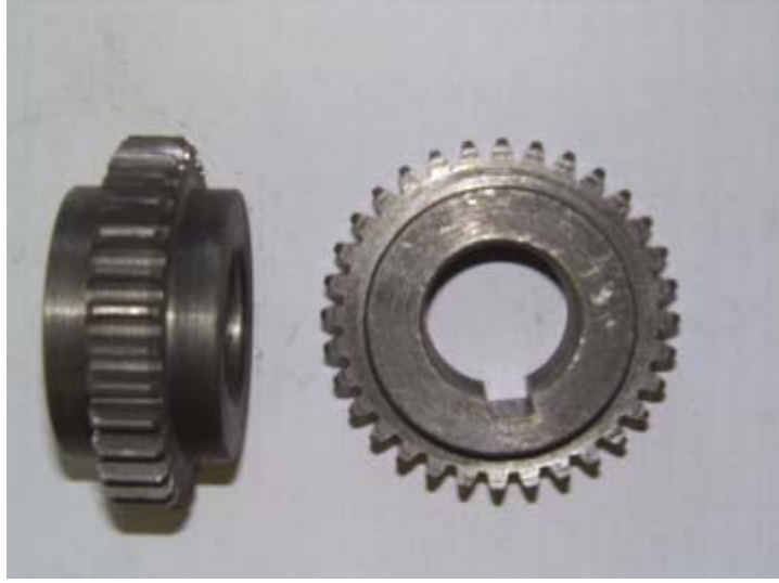
Resim 3.3 Test dişli çarklarına diş açılmış halde
