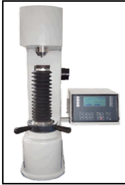
Resim 4.1 Mettest-HT sertlik ölçüm cihazı (İnt. Kyn. 3).
