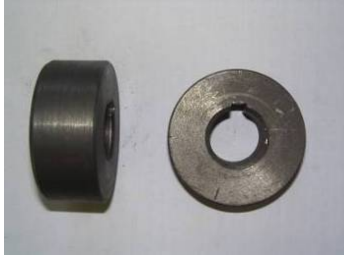
Resim 3.2 Test dişli çarklarının dişleri açılmadan önceki hali
