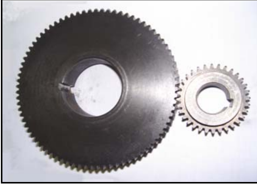
Resim 3.5 Deneysel çalışmada kullanılan çeviren ve vasat dişliler
