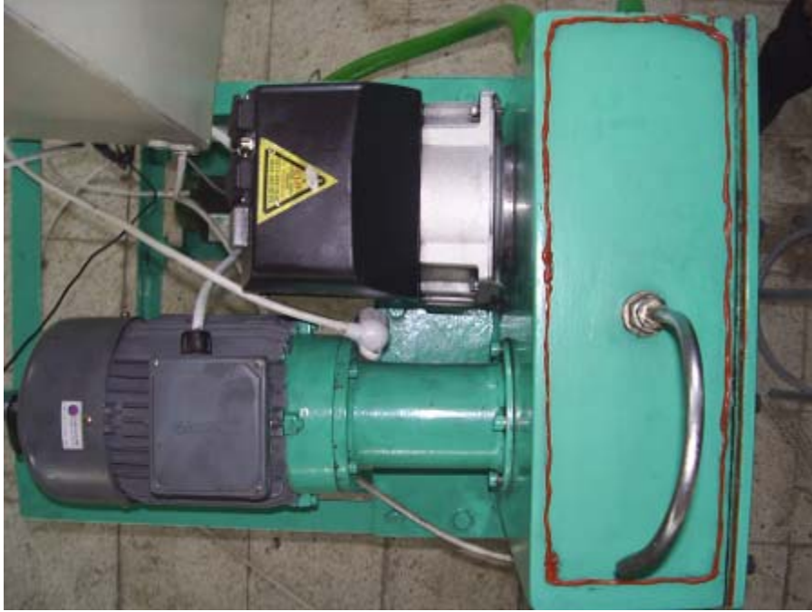
Resim 3.6 d Dişli aşınma deney cihazının üstten görünüşü
