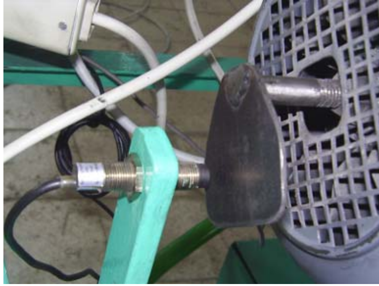
Resim 3.11 Sayıcının algılayıcı ucu elektrik motorunun arkasına yerleştirilmiş halde
