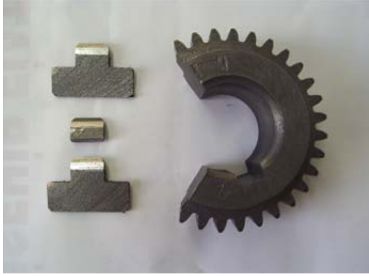
Resim 3.4 b Kesilmiş dişli ve dişleri
