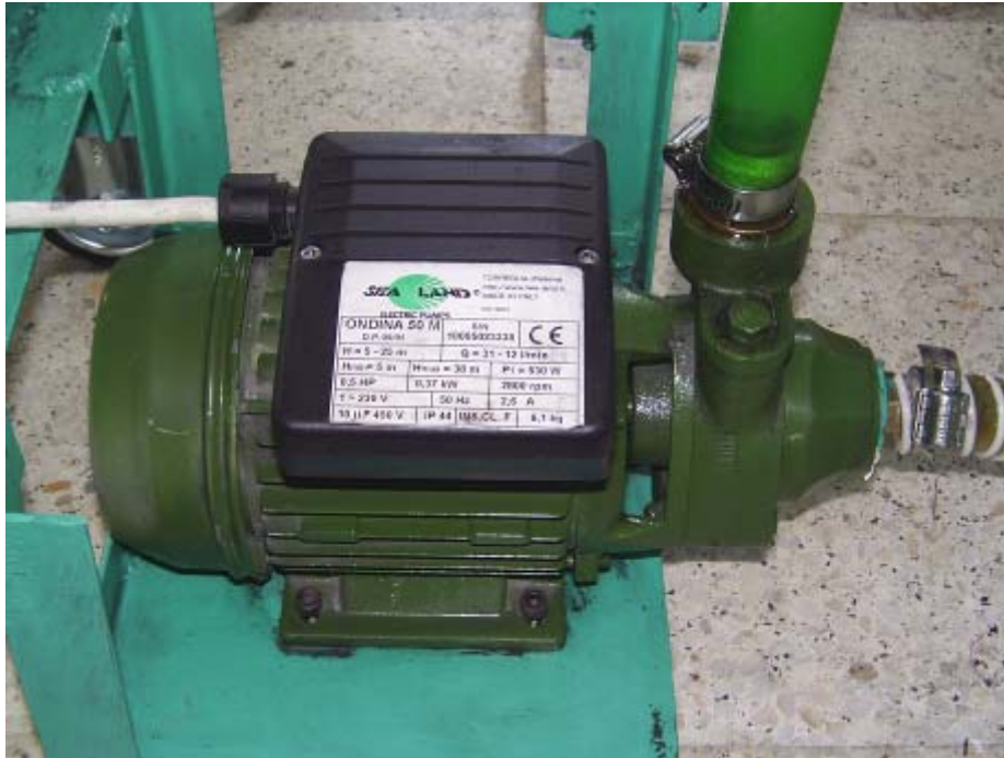
Resim 3.13 Sea Land su pompası
