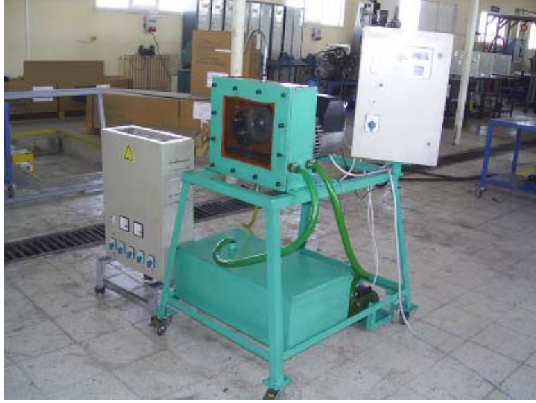
Resim 4.4 Dişli aşınma deney cihazı
