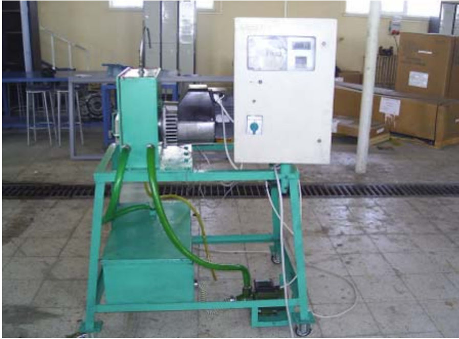
Resim 3.6 b Dişli aşınma deney cihazının yandan görünüşü
