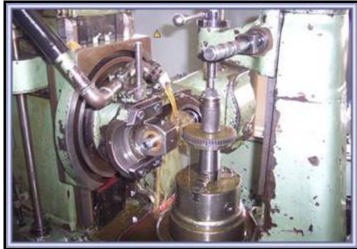
Resim 3.1 Dişli çarkların azdırma tezgahında imalatı
