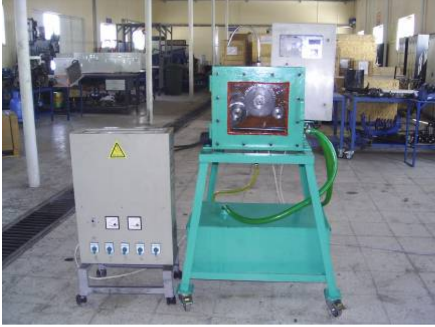
Resim 3.6 a Dişli aşınma deney cihazının önden görünüşü
