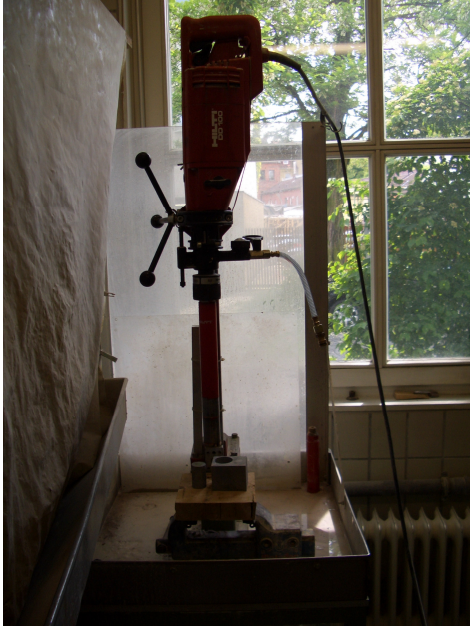
Şekil 3.2 HILTI-DD 100 Marka Karot Alma Cihazı
