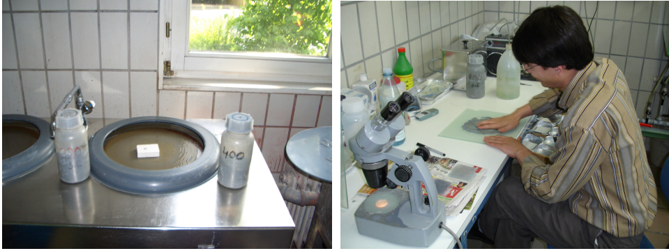
Şekil 3.6:Deney Numunelerinin Silisyum Karbürle Parlatılması
