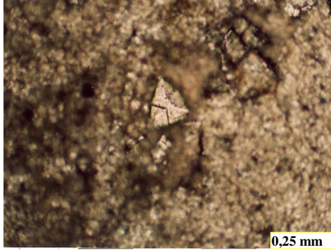
Şekil 3.20: Afyon Traverten (RT11) İçindeki Opak Mineralinin Görünümü
