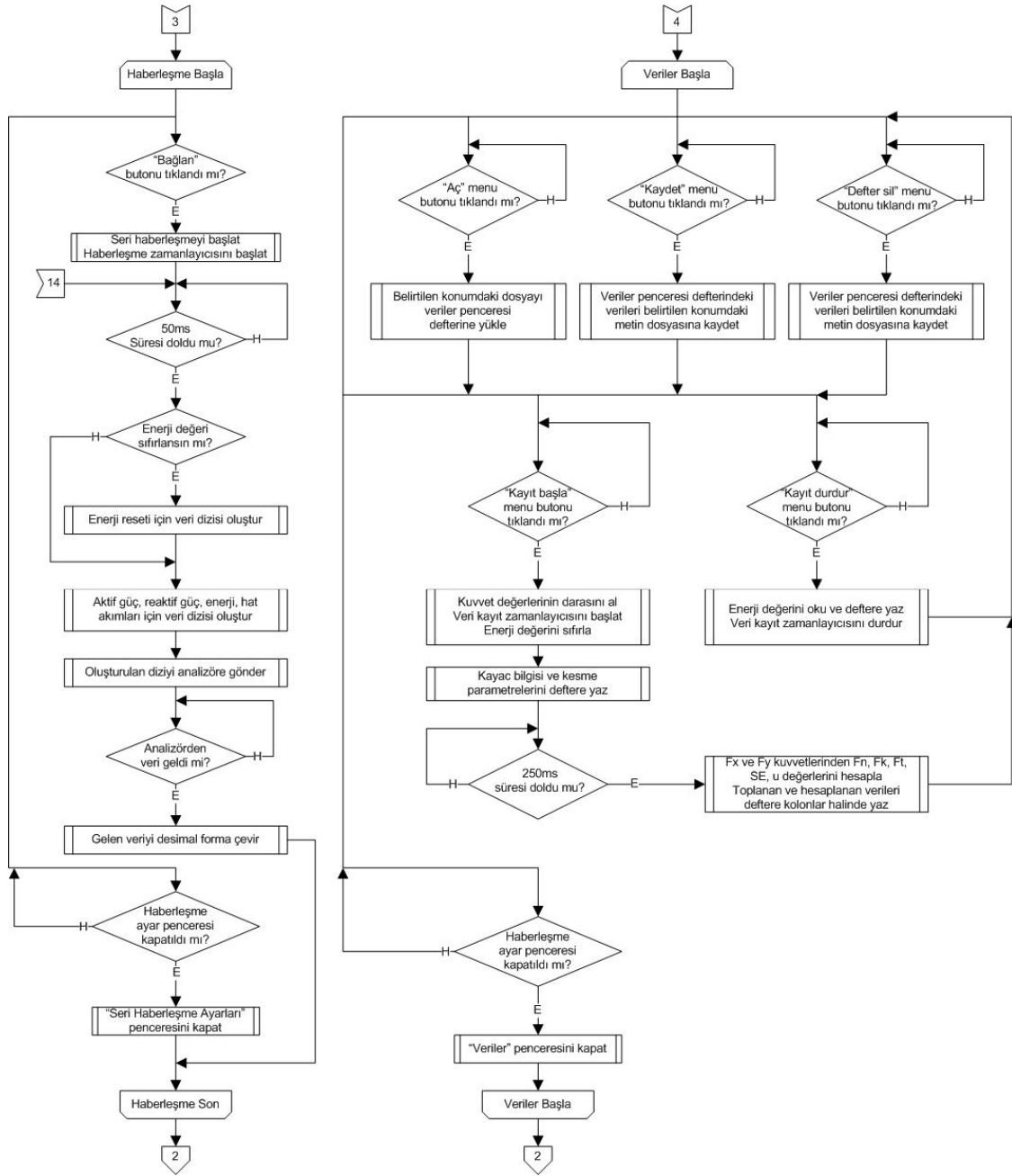
Şekil 9. Ara yüz yazılımı akış diyagramı 4
