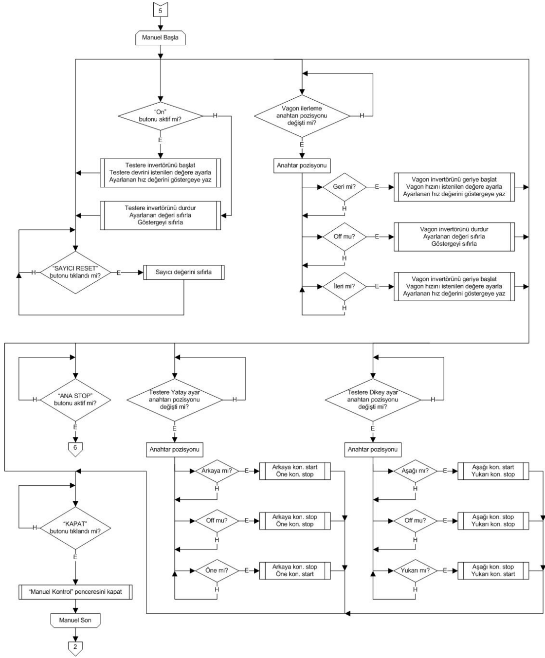
Şekil 10. Ara yüz yazılımı akış diyagramı 5
