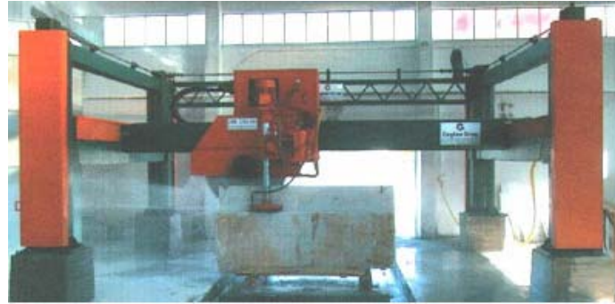
Resim 3.2. Dört kolonlu S/T mermer kesme makinesi (İnt. Kyn. 5)
