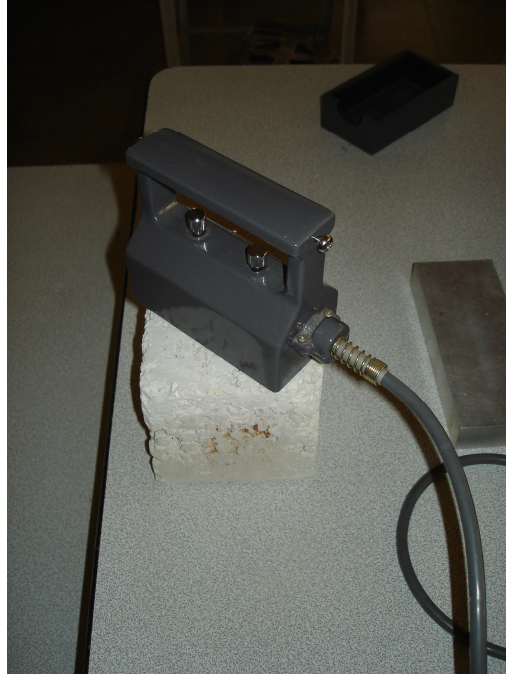
Resim 3.5.2. Shotherm Marka Isı İletkenlik Ölçüm Cihazının Probu
