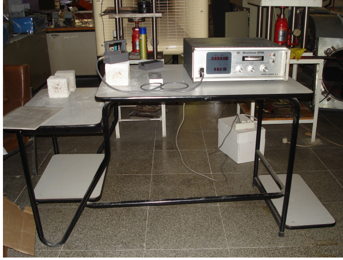
Resim 3.5.3. Cihazın Malzemedan Geçen Isı İletkenliğini Ölçmesi
