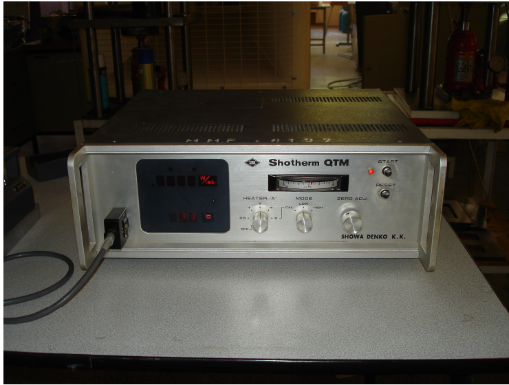
Resim 3.5.1. Shotherm Marka Isı İletkenlik Ölçüm Cihazı
