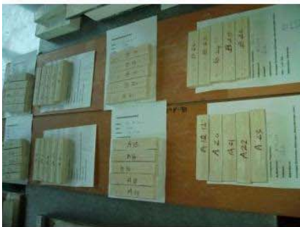
cesitli sicakliklarda sinterlenmiş numuneler
