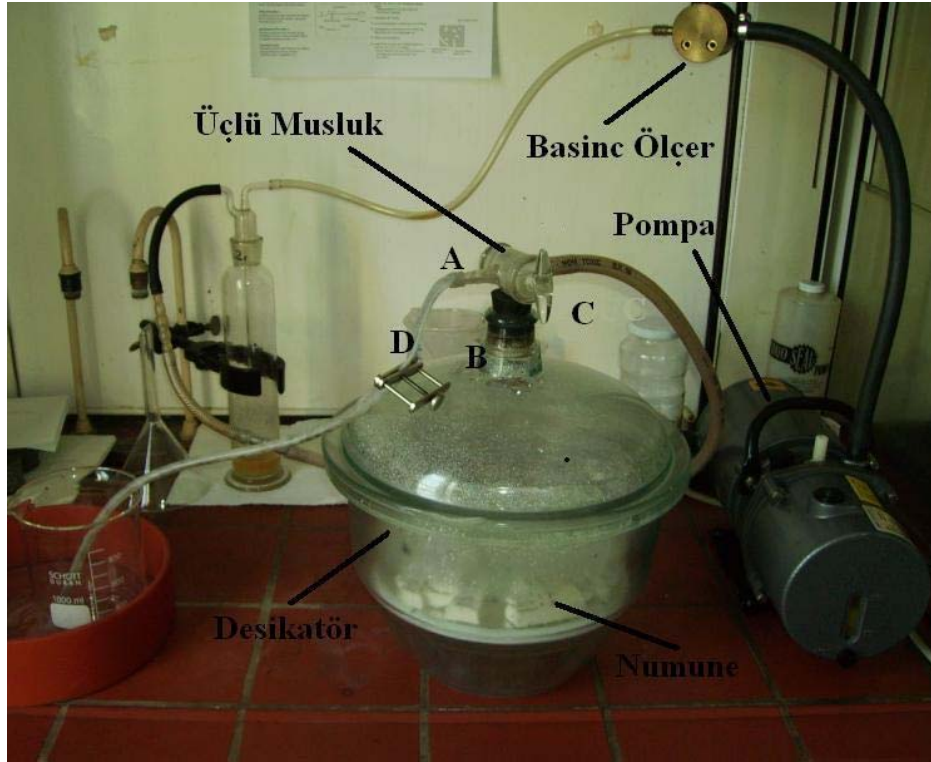
Şekil 2.6: Su emme, Açık Gözenek ve Yoğunluk testi için Desikatör düzeneği
