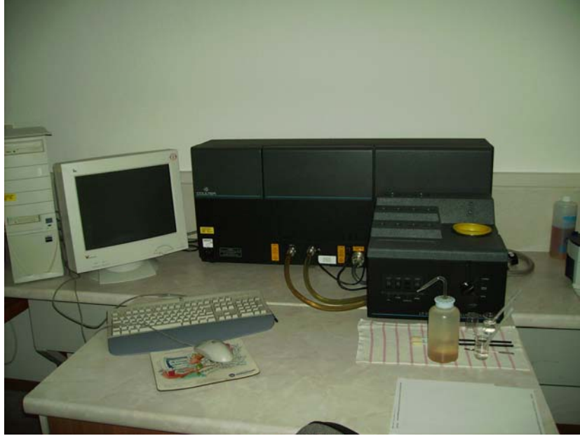
Resim 2.3: LS (laser straw light) tane boyut ölçme cihazı
