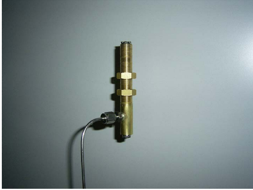
Resim 3.3. Jet sisteminde kullanılan nozzle (delik)
