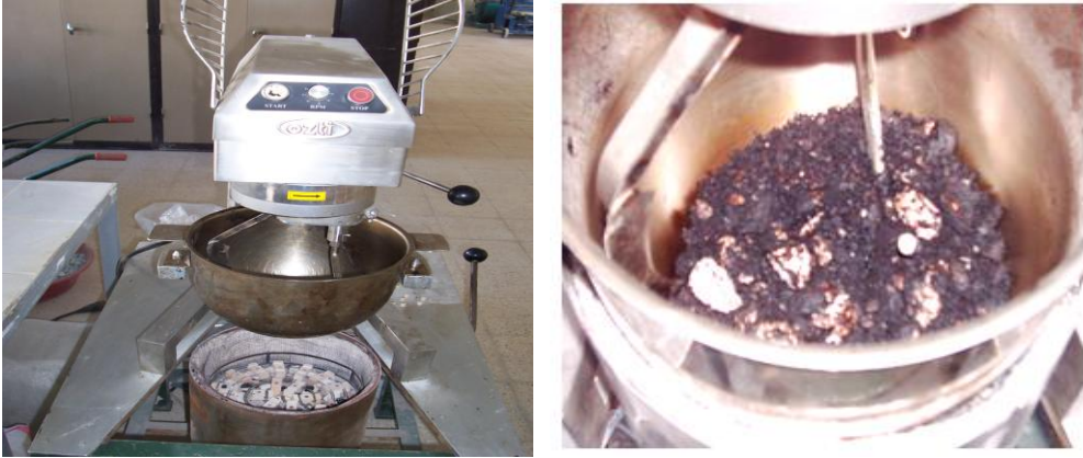
Şekil 3.9 Çalışmalarda Kullanılan Isıtıcı Mekanik Asfalt Karıştırıcısı ve Bir Karıştırma İşlemi
