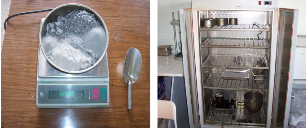
Şekil 3.8 1200 gr'lık Karışım Tartımı, Aparat ve Karışımların Isıtılması
