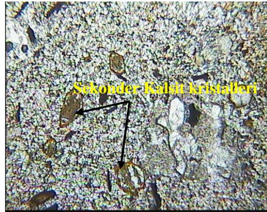
Şekil 4.42 VT Numunesi Sekonder Kalsit Kristalleri
