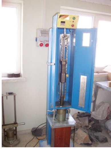
Şekil 3.10 Çalışmada Marshall Deney Numunelerini Hazırlamak İçin Kullanılan Otomatik Tokmak
