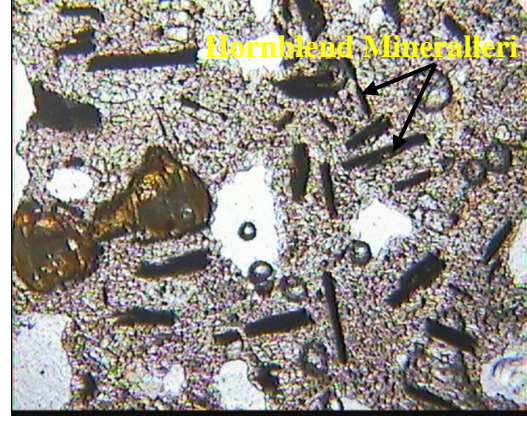
Şekil 4.38 VK Numunesi Hornblend Mineralleri
