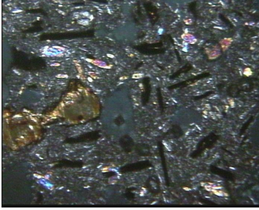
Şekil 4.38 VK Numunesi Hornblend Mineralleri
