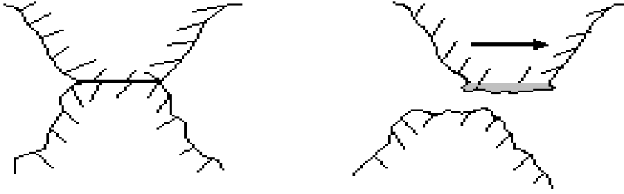
Şekil 2.7 Adhezif aşınmanın meydana gelişinin şematik olarak gösterimi (Kayalı vd. 1997).
