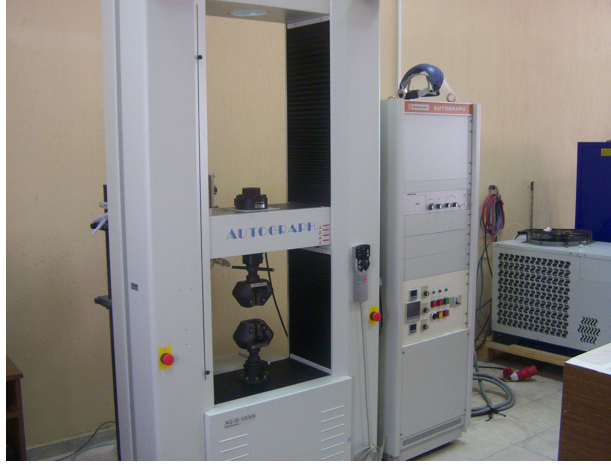
Resim 3.3 Çekme deneylerinin yapıldığı Shimadzu çekme cihazı.
