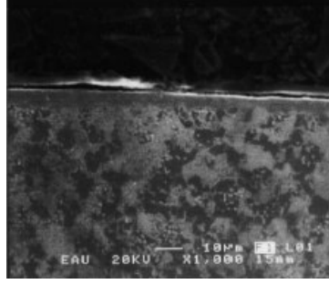
Şekil 2.5 Nitürlenmiş malzemede (AISI 5140) nitürürlü tabakanın SEM görünüşü, T = 450\text{ }^\circ\text{C} , t = 4 saat (Çelik vd. 2002).
