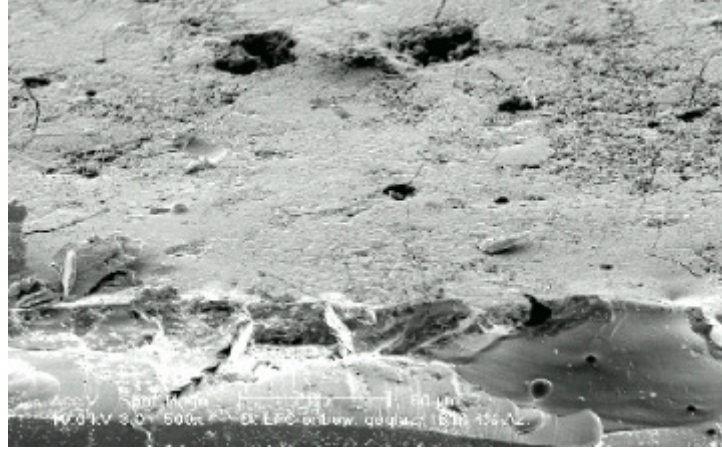
Şekil 2.23. Sırlı Duceram LFC numunelerindeki sırlama hataları ile meydana gelen yüksek gerilim konsantrasyonlu noktalardaki çatlakların SEM görüntüleri (Jager et al. 2000).
