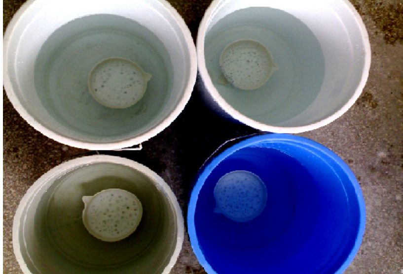
Resim 3.1. Porselen tozların fritleştirilmesi işlemi
