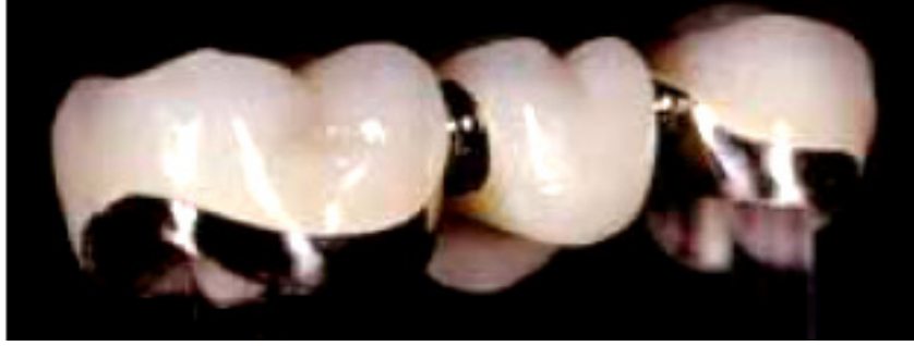
Resim 2.8. Metal altlık (altın) üzerine ergitilmiş düşük ergime sıcaklıklı porselen (Finesse, Dentsply Ceramco) (Leinfelder et al. 2000)
