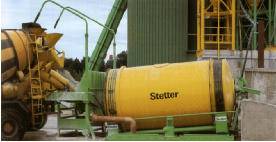
Resim 3.2 c- Beton Boşaltım Oluđu
