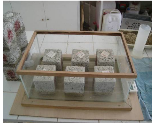
Resim 3.9 Kılcallık deneyi için geliştirilen deney düzeneği.
