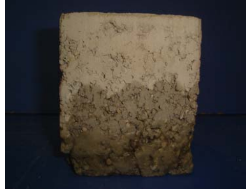
Resim 4.1 (a),(b) Kılcallık deney düzeneği ve numunede kılcal suyun yükselmesi.
