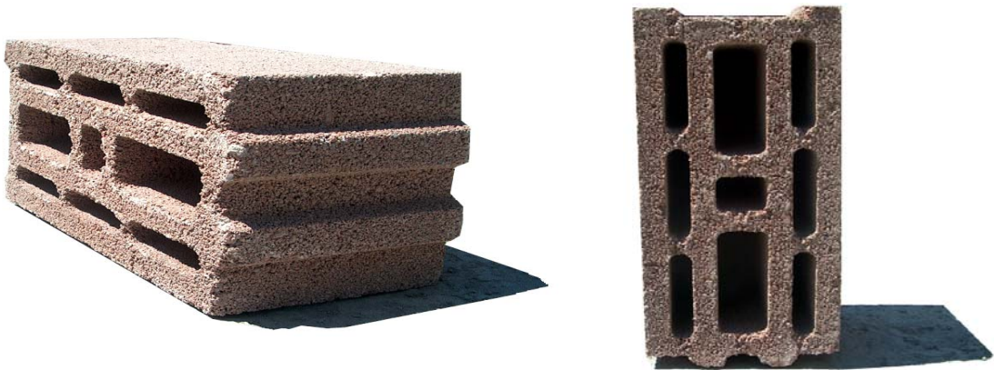
Şekil 2.3 Pomza agregası kullanılarak üretilen inşaat malzemesi (biriket).
