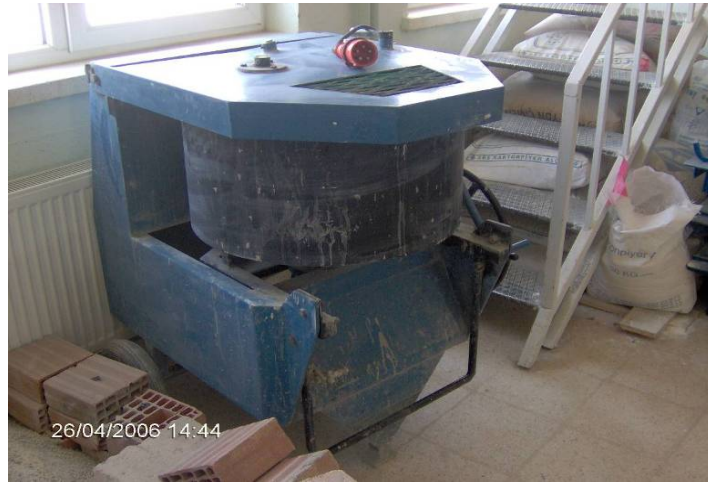
Resim 3.2 Üretimde kullanılan betonier.
