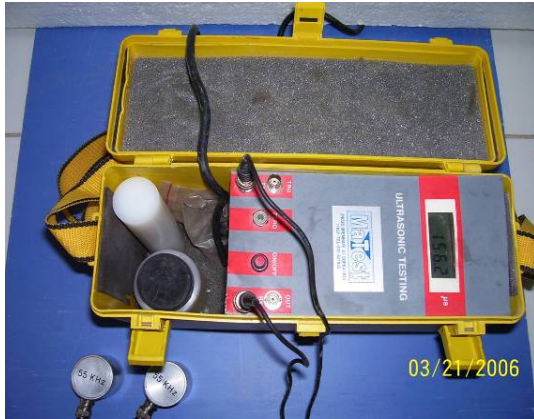
Resim 3.10 Deneylerde kullanılan ultrases cihazı.
