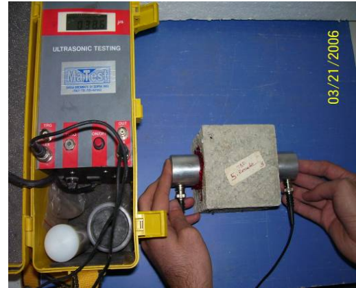
Resim 3.11 Deney numunesinin ultrases cihazı ile ölçüm yöntemi.
