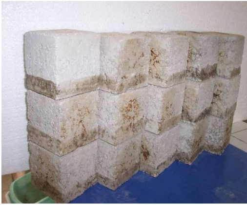
Resim 3.8 Kılcallık için parafinlenen numuneler.
