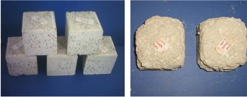
Resim 3.15 Donma-çözünmeye tabi diyatomit numuneleri (Deney öncesi-sonrası)
