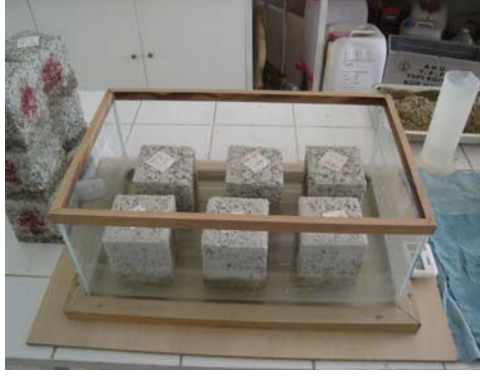
Resim 4.1 (a),(b) Kılcallık deney düzeneği ve numunede kılcal suyun yükselmesi.
