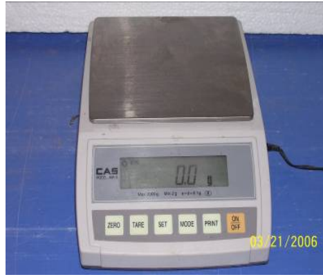
Resim 3.4 Numune tartılmasında kullanılan terazi.
