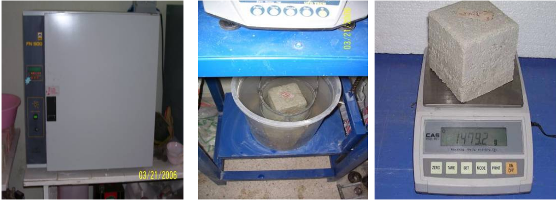
Resim 3.5 Numunelerinin kurutulmasında kullanılan etüv.
