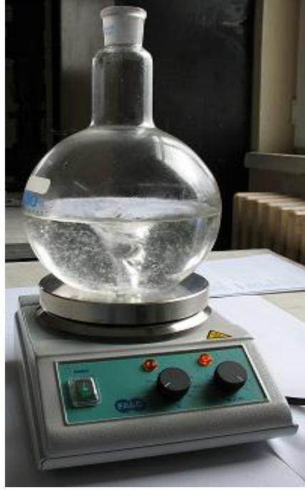
Resim 4.1. Metil alkol içerisinde KOH' un çözülmesi
