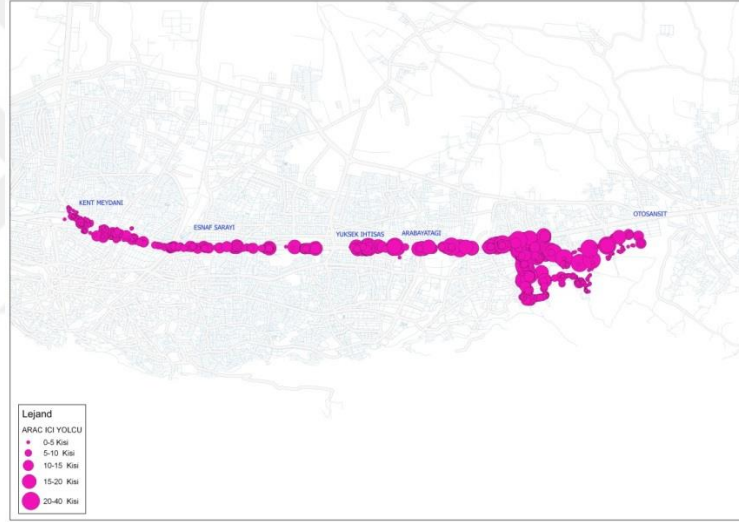
Şekil 7 Arabayatağı Minibüs Hattında Coğrafi Yolcu Yoğunluğu (Kaynak: Bursa Büyükşehir Belediyesi)
