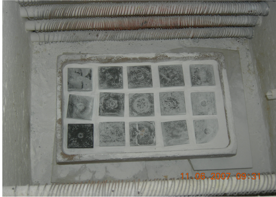
Resim 3.4: Enjeksiyonla kalıplanan parçaların fırından çıkarılması
