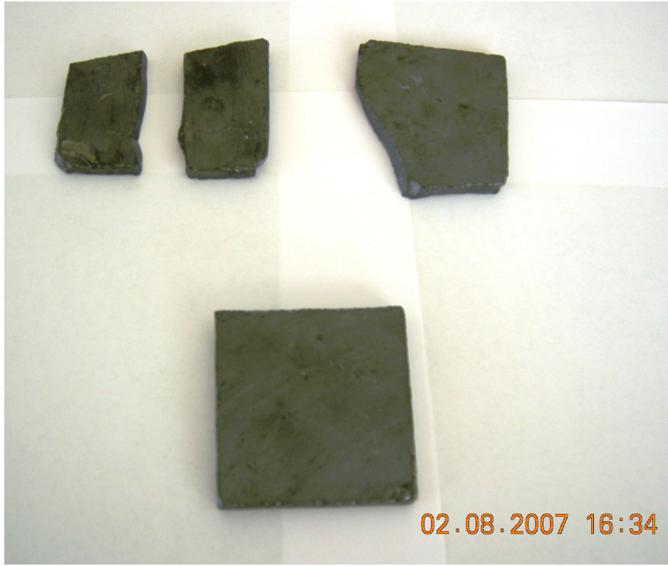
Resim 3.7 : Slip dökümle kalıplanan parçaların sıcak preste sinterleme sonrası görünümü
