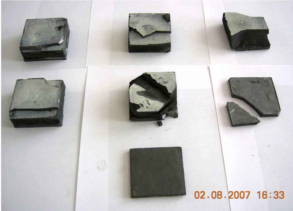
Resim 3.6 : Enjeksiyonla kalıplanan parçaların sıcak preste sinterleme sonrası görünümü
