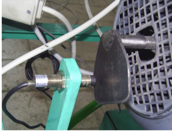
Resim 3.11 Sayıcının Algılayıcı Ucu Elektrik Motorunun Arkasına Yerleştirilmiş Halde
