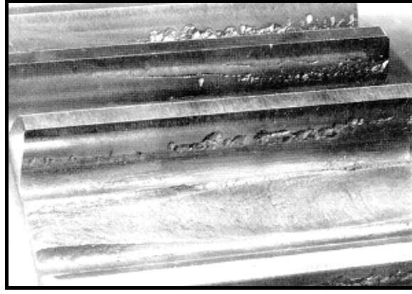
Resim 2.14 Pitting Kaynaklı Kırılma
