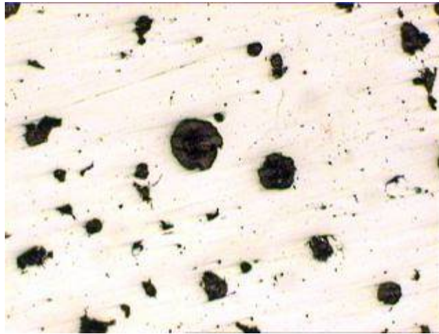
Resim 3.19a Küresel Grafitli Dökme Demir Malzemesine Ait Mikro Yapı (Dağlamasız x100)
