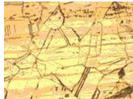
Resim 9.3 Jominy deneyi sonrasında AISI 304 çeliğine ait mikro yapılar ( 100x )
