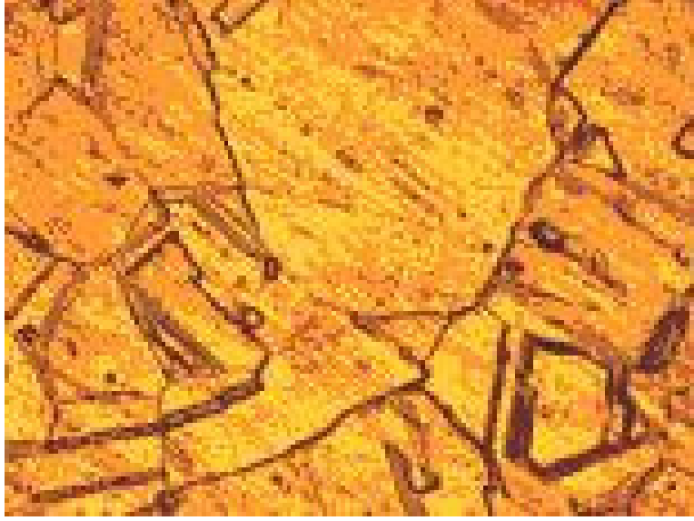
Resim 7.3 SAE/AISI 304 Çeliğinin ısıtım öncesi sertliği ve mikro yapısı ( 100x )
