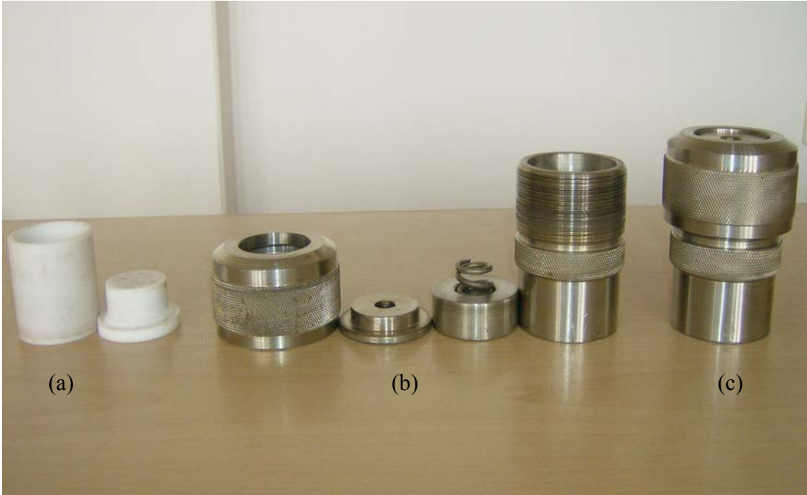
Resim 3.1 (a) Teflon reaksiyon kabı ve kapağı (b) Basınca dayanıklı asit sindirme kabı ve parçaları (c) Deneye hazır, kapalı reaksiyon kabı
