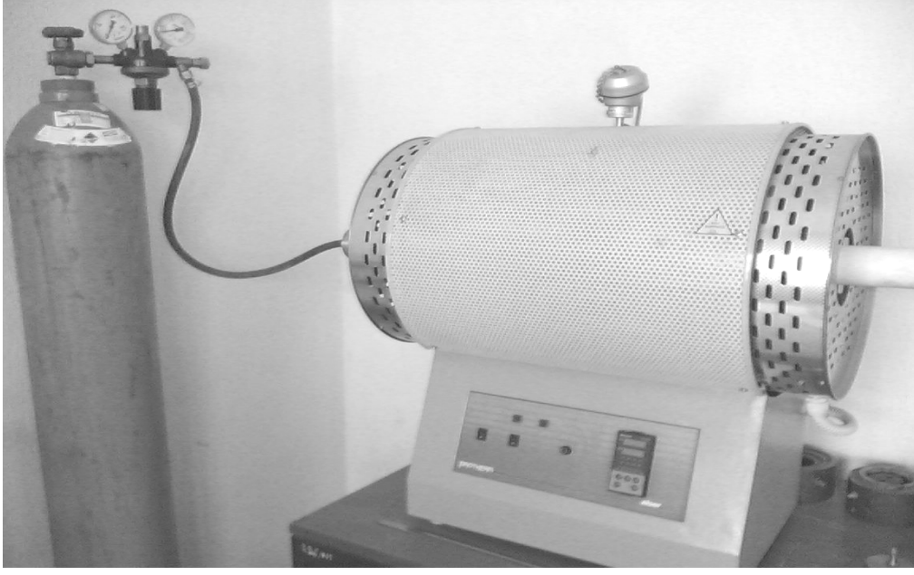
Şekil 11. Argon gazı atmosferinde sinterleme işlemi için kullanılan tüp fırın.
