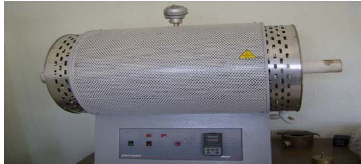
Şekil 21. Sinterlemede kullanılan tüp fırın.
