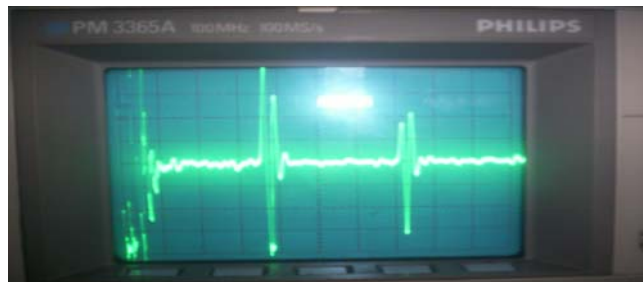
Şekil 24. A-Scan görüntüsündeki pikler ve numuneden alınan pik görüntüleri.
