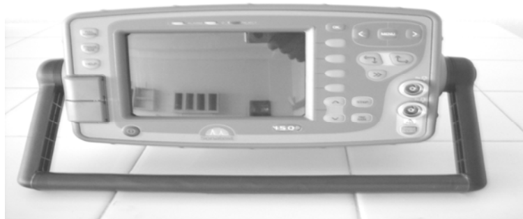
řekil 22. Ultrases boyuna hız ölçüm cihazı.
