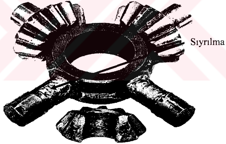
Şekil 3.23 İstavroz Dişlileri ve Milinde Sıyırılma(Hema 1993).
