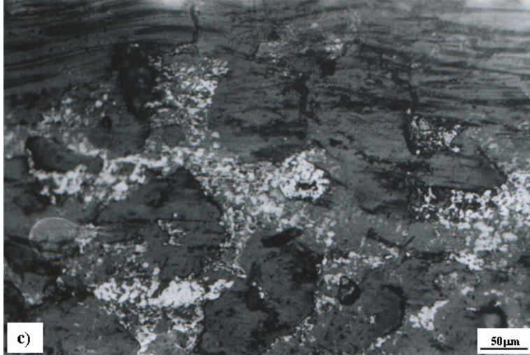
Şekil 7.17 900 °C’de 1 saat süre ile borlanmış a) 300 °C, b) 350 °C ve c) 450 °C’de bortemperlenmiş numunenin yüzeyine uygulanan aşınma deneylerinde oluşan izlerin mikroyapı görüntüleri.
