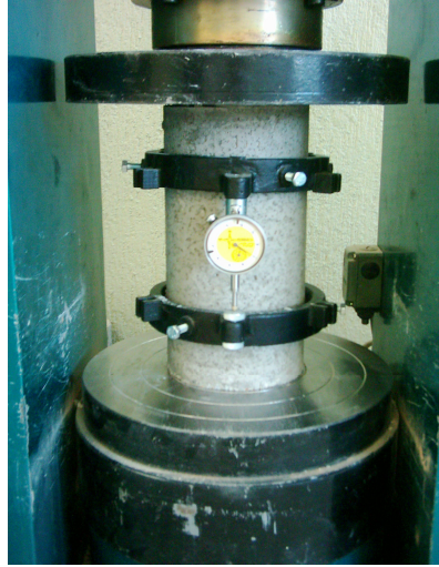
Şekil 3.7 Silindir Numunelerde Yük-Birim Boy Kısalma Ölçümü
