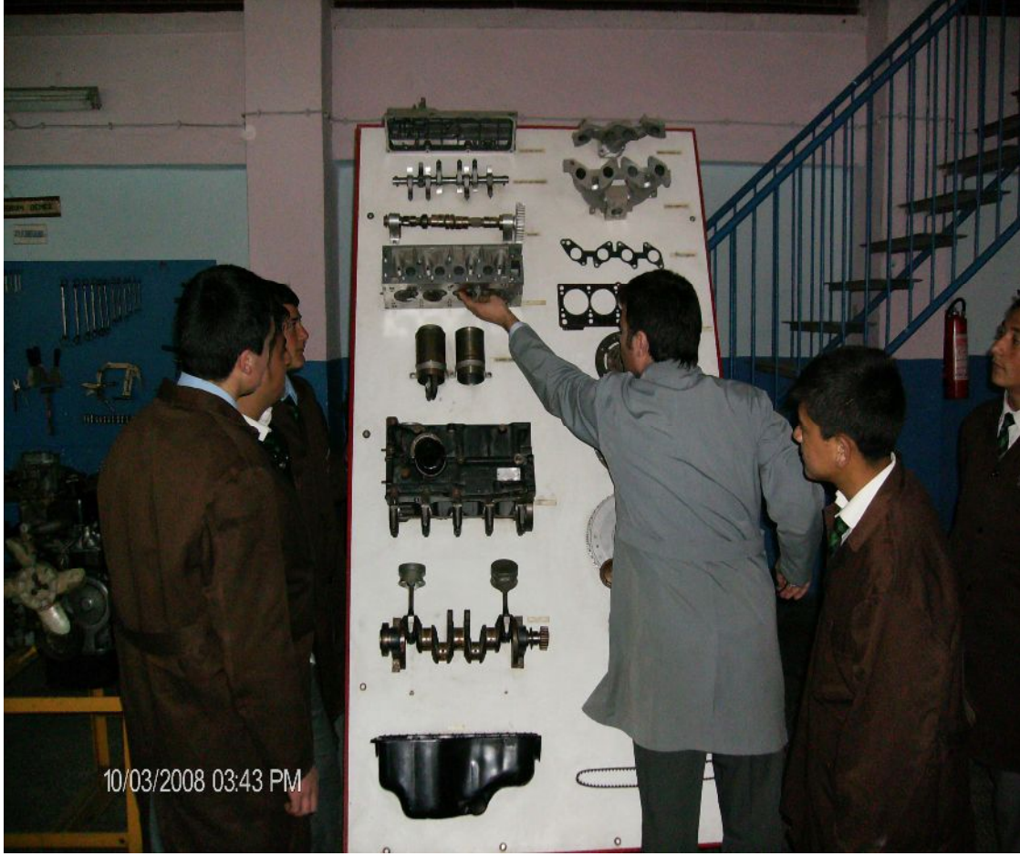
Resim 2.8 Montaj sırasına göre pano üzerine monte edilmiş motor parçalarının tanıtılması
