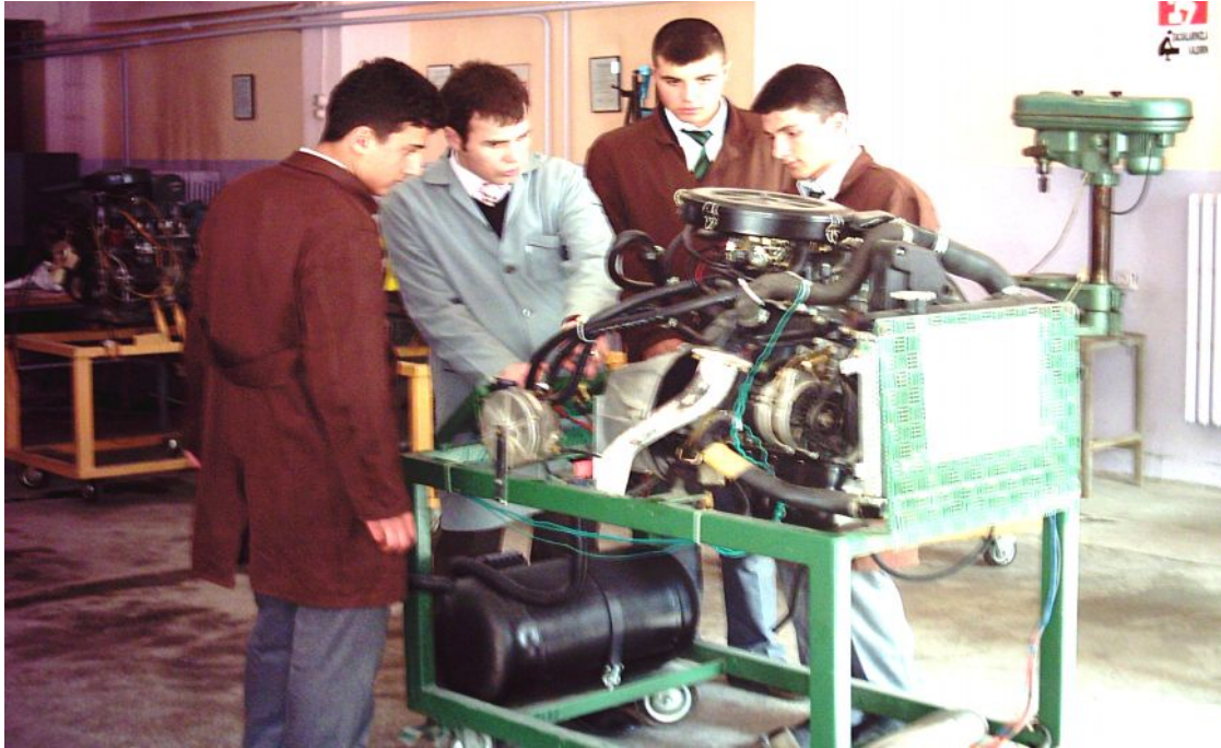
Resim 2.14 LPG Montajı Yapılmıř Uzaktan Kumandalı Tofař Tempura Motoru
