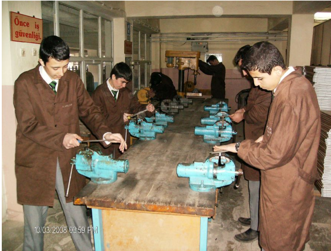
Resim 2.5 Temel mekanik atölyesinde el tesviyesi yapan öğrenciler
