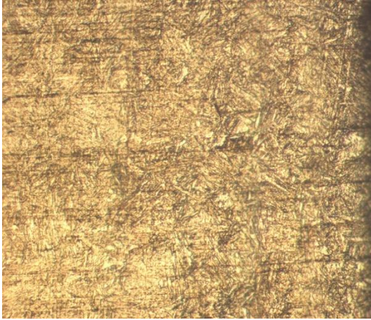
e) Hardox 500 Tel Erozyon İle Kesme 200 Kat Büyütülmüş
