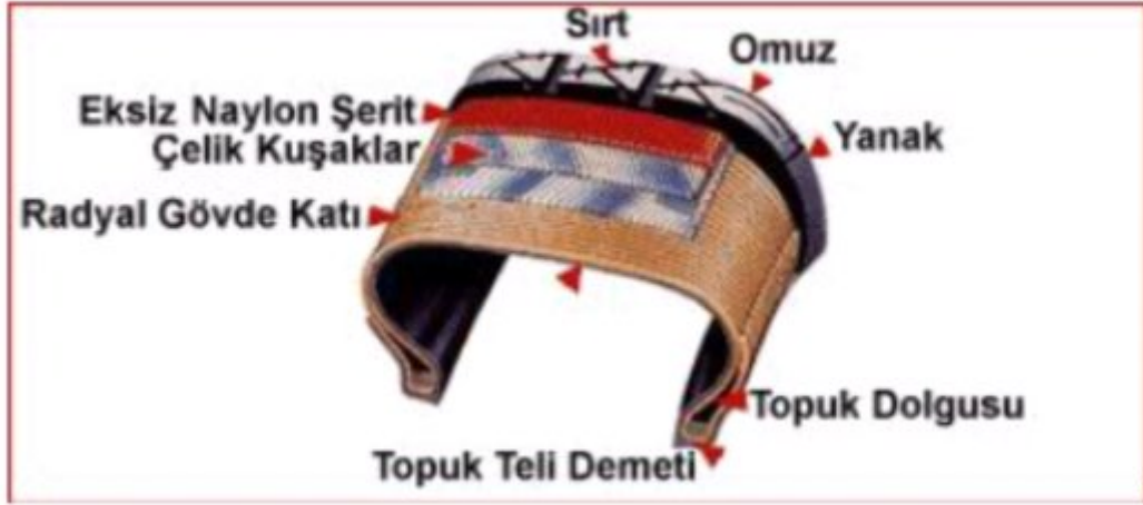
Şekil 1.1 Lastiğin oluşum yapısı (Karapaça 2005)
