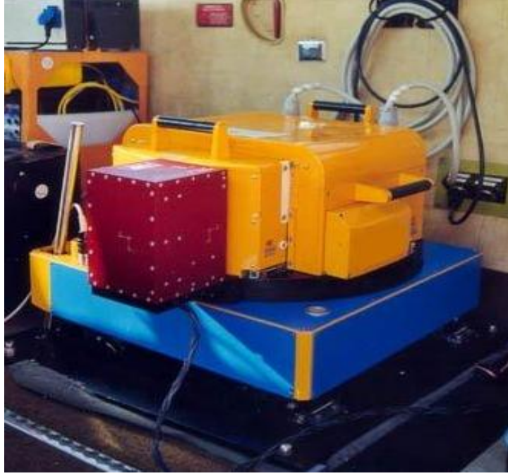
Resim 8.1 Zeiss/Jena LC0030 analog fotogrametrik hava kamerası
