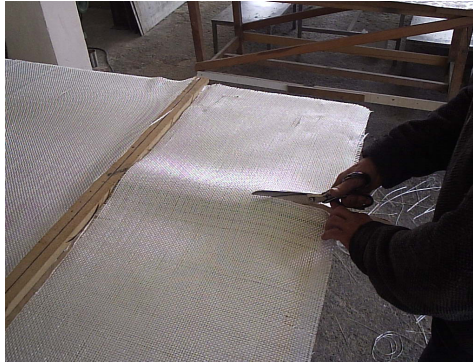
Resim 3.5 Dokuma şeklindeki cam elyaf takviyesinin kesilmesi
