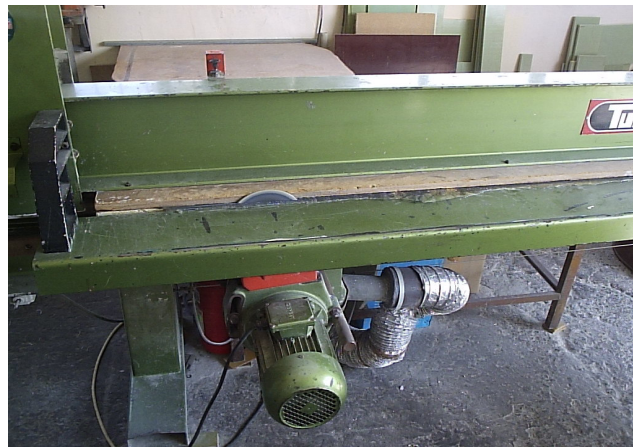
Resim 3.9 Kompozit malzemenin kenarlarının kesilmesinde kullanılan testere
