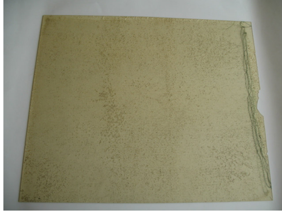
Resim 3.4 Üretilen örme cam kumaş takviyeli kompozit malzeme plakasının genel görünüşü
