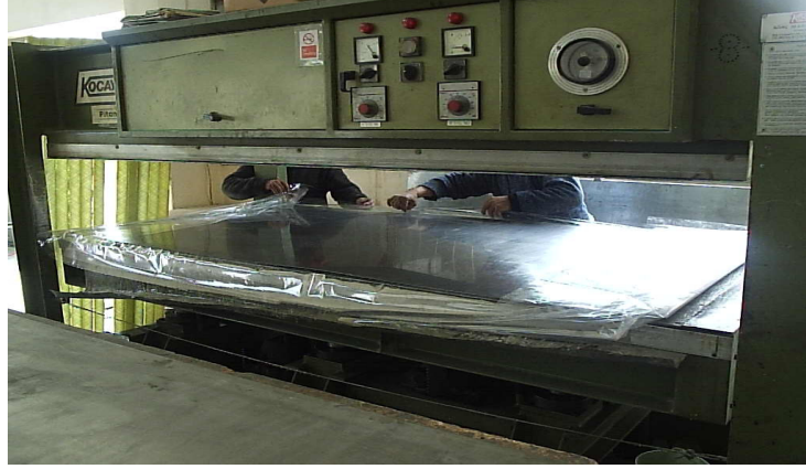
Resim 3.8 Kompozit malzemenin preste yerleştirilmesi
