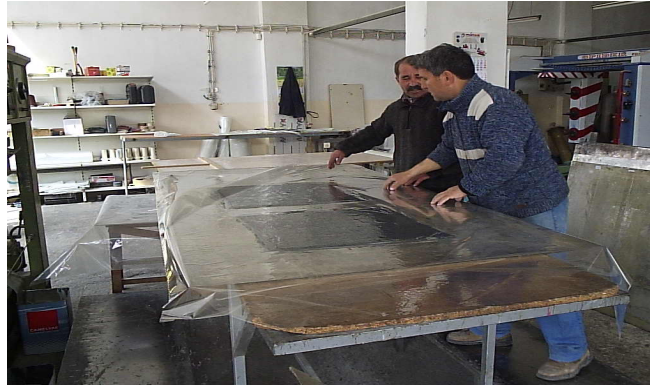
Resim 3.7 Kompozit malzemenin preste konulmadan önceki görünüşleri
