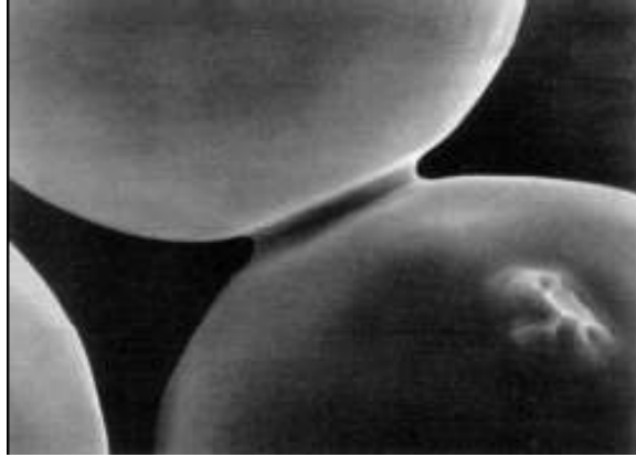
Şekil 2.7 Boyun oluşumunu SEM görüntüsü [İnt. Kyn. 7].
