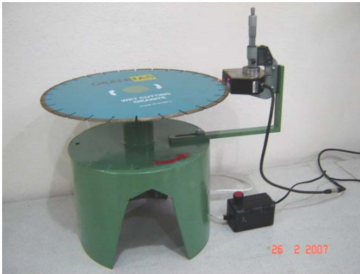
Resim 5.11 Soketlerde meydana gelen aşınmanın ölçümü için tasarlanmış düzenek.
