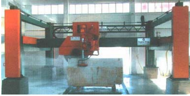
Resim 3.2 İki kolonlu S/T mermer kesme makinesi (İnt. Kyn. 1)
