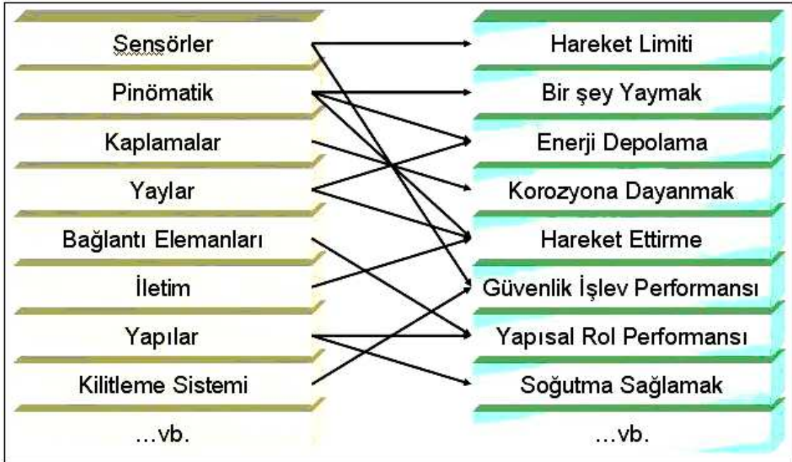
Şekil 4.17. Çeşitli makine/elektrik elemanlarının işlevleri
